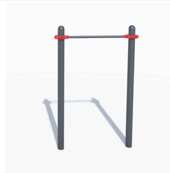
Комплекс состоит из двух опорных столбов высотой 2600мм и перекладины для подтягиваний длиной 1200 мм, которая фиксируется при помощи хомутов на высоте 2450 мм. Длина комплекса не более 1450 мм
