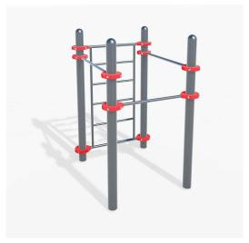
Комплекс состоит из четырех опорных столбов высотой: 3 шт. - 2600 мм, 1 шт. - 2300 мм, шведской стенки и трех перекладин для подтягиваний. Элементы крепятся к опорным столбам при помощи хомутов. Шведская стенка крепится на высоте 2450 мм. Состоит из перекладин, расстояние между которыми 373 мм. Высота шведской стенки - 2073 мм, ширина - 1200 мм. Высота фиксации перекладин для подтягиваний: 1 шт. - 2300 мм, 1 шт. - 2100 мм, 1 шт. - 2000 мм. Длина комплекса не более 1450 мм.
