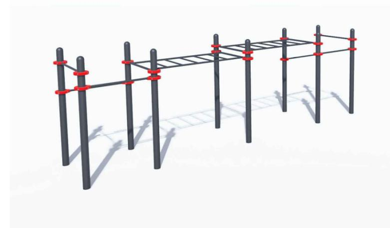
Комплекс состоит из десяти опорных столбов высотой 2600 мм, шести перекладин для подтягиваний длиной 1200 мм и двух секций рукохода. Элементы крепятся к опорным столбам при помощи хомутов. Высота фиксации перекладин для подтягиваний: 1 шт. - 2450 мм, 1 шт. - 2400 мм, 1 шт. - 2250 мм, 1 шт. - 2100 мм, 2 шт. - 1800 мм. Высота фиксации секций рукохода: 1 шт. - 2150 мм и 1 шт. - 2450 мм. Длина каждой секции 1900 мм. Шаг рукохода 310 мм. Длина комплекса не более 6500 мм.
