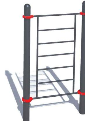
Комплекс состоит из двух вертикальных опорных столбов высотой 2600 мм, и шведской стенки. Шведская стенка состоит из перекладин, расстояние между которыми 373 мм. Высота шведской стенки 2073 мм. Ширина шведской стенки 1200 мм. Крепится к вертикальным опорным столбам при помощи хомутов на высоте 2450 мм. Длина комплекса не более 1450 мм.
