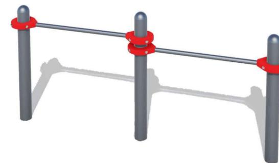
Комплекс состоит из трех опорных столбов высотой 2 шт. - 2600 мм, 1 шт. - 2300мм и двух перекладин для подтягиваний длиной 1200мм, которые крепятся к опорным столбам при помощи хомутов на высоте: 1 шт - 2400 мм и 1 шт. - 2100 мм, Длина комплекса не более 2800 мм.
